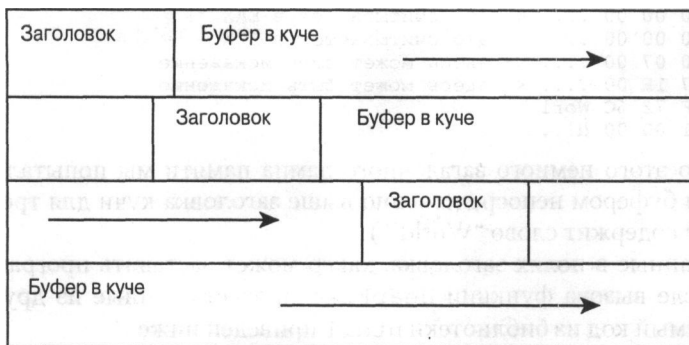
Рис. 7.14. Направление роста буферов в куче на стандартной платформе
