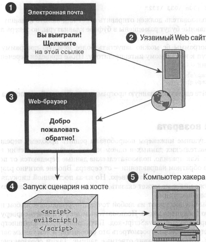
Рис. 5.1. Злоумышленник отправляет сообщение с активным содержанием на атакуемую систему (1), которое активизирует сценарий на уязвимом Web-сайте (2). Затем после активизации Web-браузера, запрашивающего информацию со взломанного Web-сайта (3), запускается вредоносный сценарий (4), который предоставляет хакеру возможность доступа (5)
