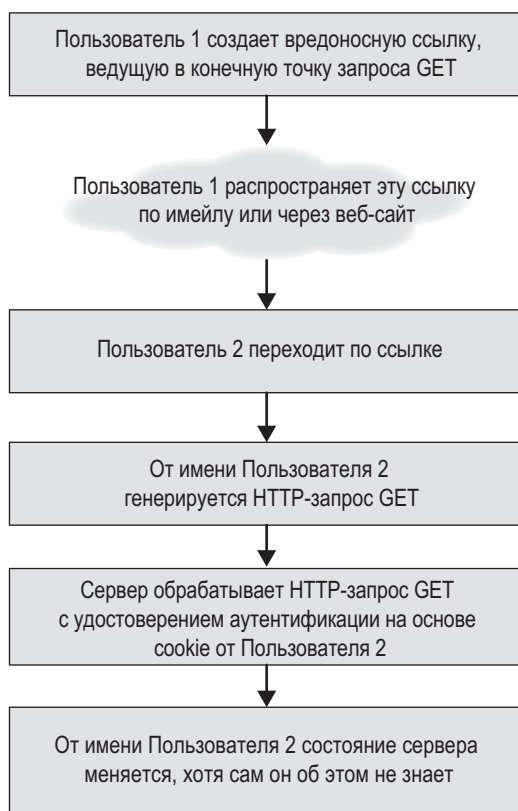
Рис. 11.1. CSRF — это распространение вредоносной ссылки, щелчок на которой вызывает выполнение HTTP-запроса GET от имени аутентифицированного пользователя
