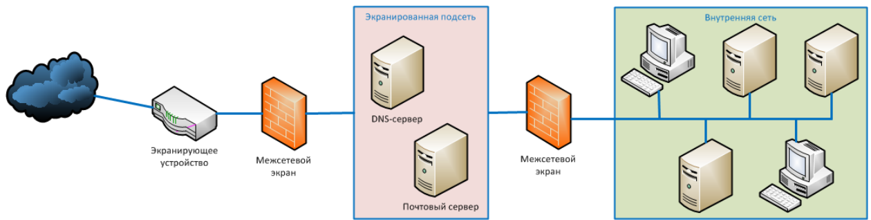
Рисунок 5-38 В экранированной подсети два межсетевых экрана используются для создания DMZ
