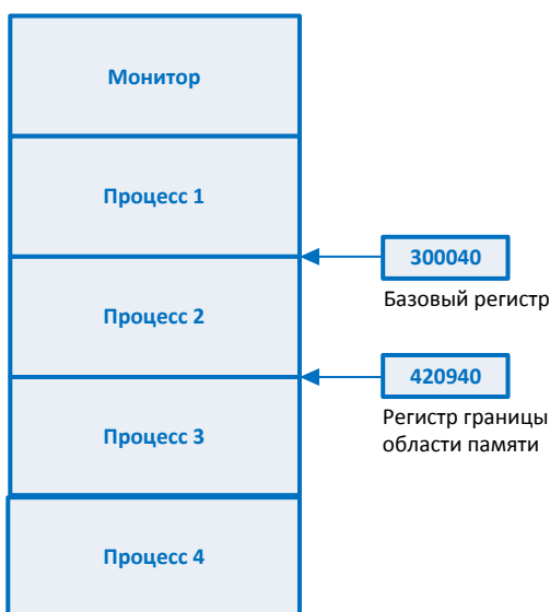
Рисунок 3-6 Базовый регистр и регистр границы области памяти используются для контроля выхода процесса за пределы своего сегмента памяти
