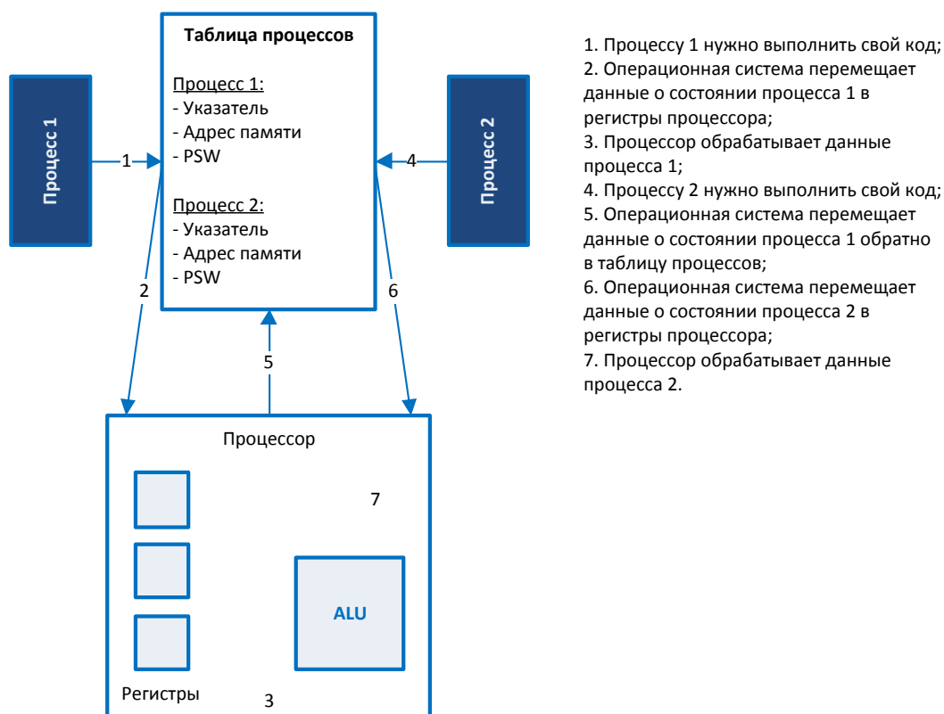
Рисунок 3-5 Таблица процессов содержит данные о состоянии процессов, которые необходимы процессору
