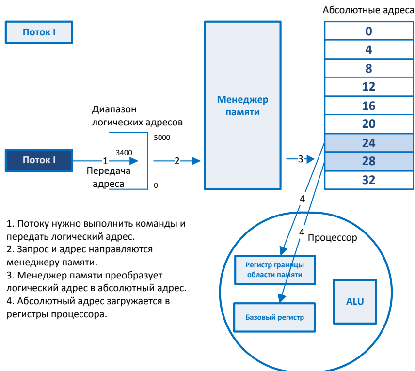
Рисунок 3-9 Процессор использует абсолютные адреса, а приложения – логические
