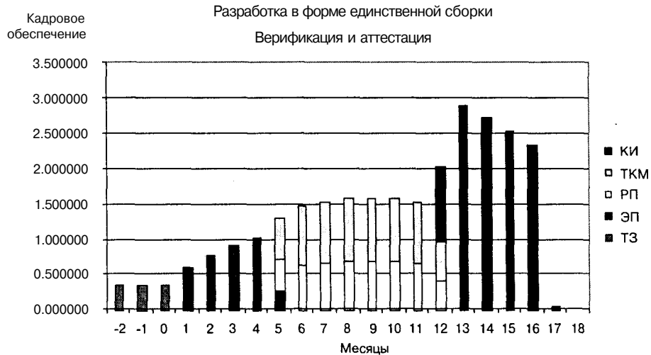
Рис. 12.20. Кривая кадрового обеспечения верификации и аттестации для каскадной модели выполнения проекта в 75 KLOC
