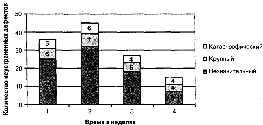
Рис. 5.8. Пример отчета об устранении дефектов
